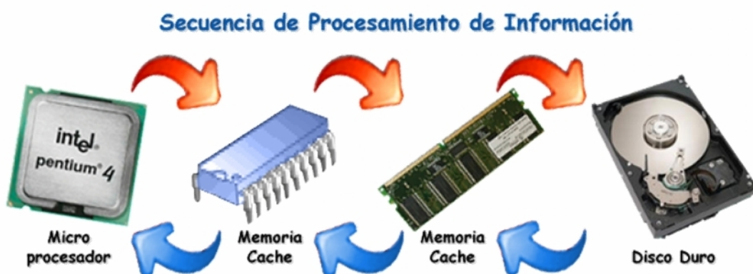
La Información viaja del Disco Duro (u otro componente) hacia el procesador para su respectivo tratamiento y luego regresa al lugar de origen para su almacenamiento.
