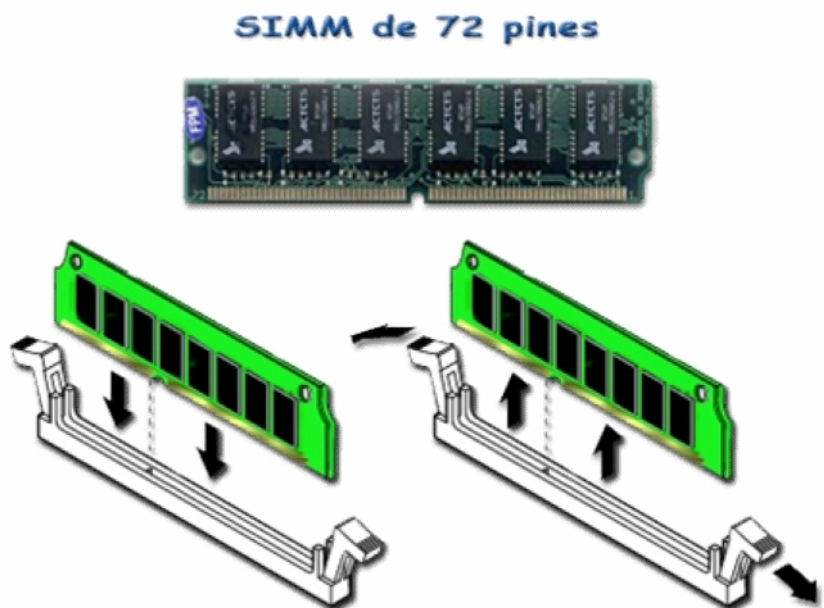
Las memorias SIMM poseen una sola muesca, por lo cual es fácil de instalar en placas que tengan diferentes bancos de memoria.
