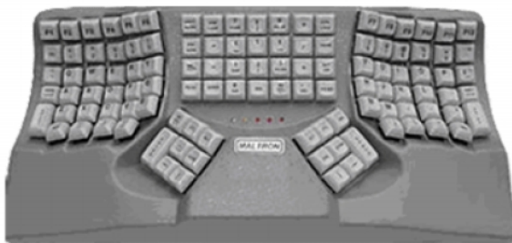
Teclado ergonómico MALTRON, fabricado a mano, permite usar más los pulgares ofreciendo en 20 % mayor comodidad y velocidad.
